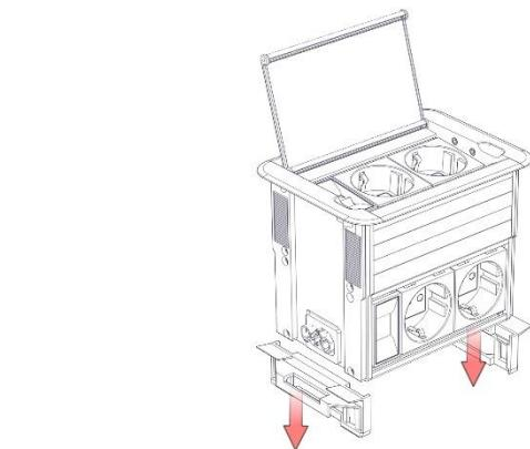
Postaviti uređaj u izrezani otvor i polako ga spustiti dok obod uređaja ne dodirne gornju površinu.
