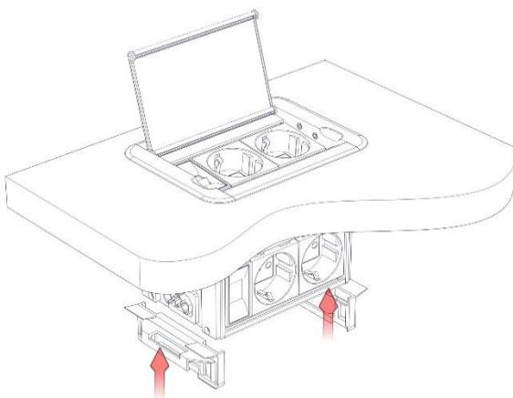
Klizne fiksatore vratiti na uređaj snažno ih gurajući na gore sve dok se uređaj ne fiksira za ploču radne površine. Povezati uređaj na niskonaponsku mrežu preko kabla.
