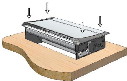
Uređaj je spremam za pozicioniranje u pripremljeni otvor u stolu.
