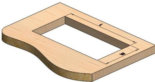
U radnoj površini u koju se želi ugraditi uređaj, na željenom mestu izrezati otvor dimenzija datim na pakovanju
